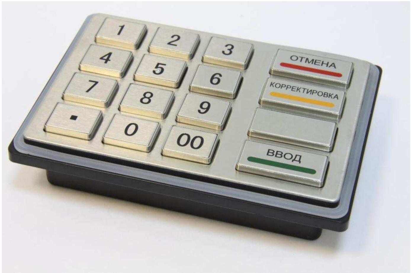
Антивандальная 16-ти кнопочная криптующая цифровая клавиатура ZT588Ca предназначена для использования в банкоматах, платежных терминалах, системах контроля доступа, информационных киосках.
